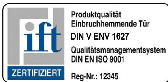
Bild 4 Kennzeichnungsschild für einbruchhemmende Türen nach DIN V ENV 1627
